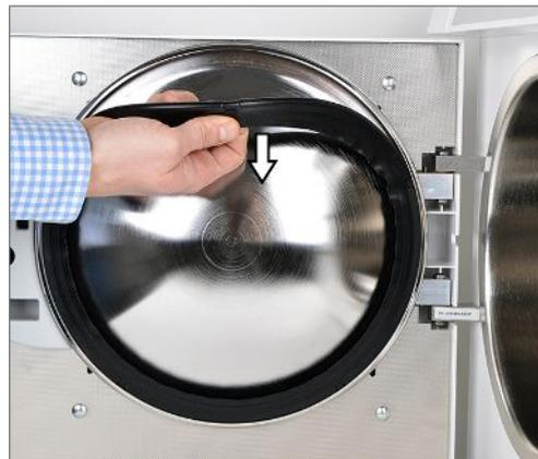
2. Setzen Sie die Türdichtung in die Nut der Türrolle ein.
